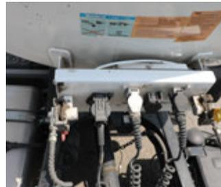
شكل رقم 13: توصيل الصهرج كهربائياً مع هيكل الشاحنة
