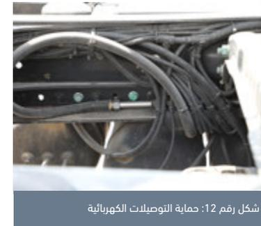
شكل رقم 12: حماية التوصيلات الكهربائية
